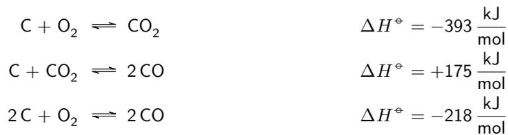
Da die Entropie bei der Bildung von Kohlenmonoxid steigt, verschiebt der Term  $-T \cdot \Delta S$  das Gleichgewicht bei hohen Temperaturen auf die Seite des Kohlenmonoxids.
