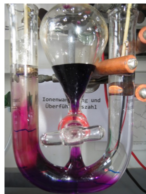
Abbildung 1: Versuchsaufbau mit eingespanntem U-Rohr und Elektroden
